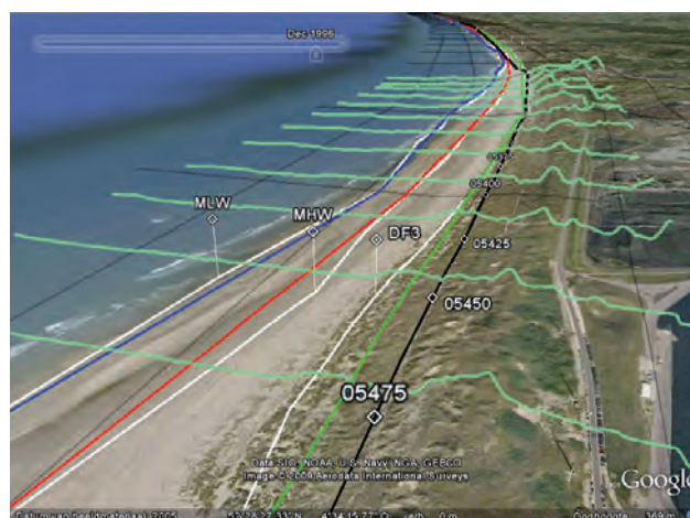
Приложение за визуализация на данни чрез използване на Google Earth , което е на разположение в базата данни OpenEarth . Примерът илюстрира плажен профил и положение на бреговата линия, измерени в Холандия.
