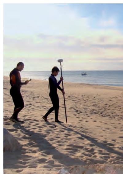
Levantamiento topográfico de playa con GPS en Praia de Faro, Portugal
